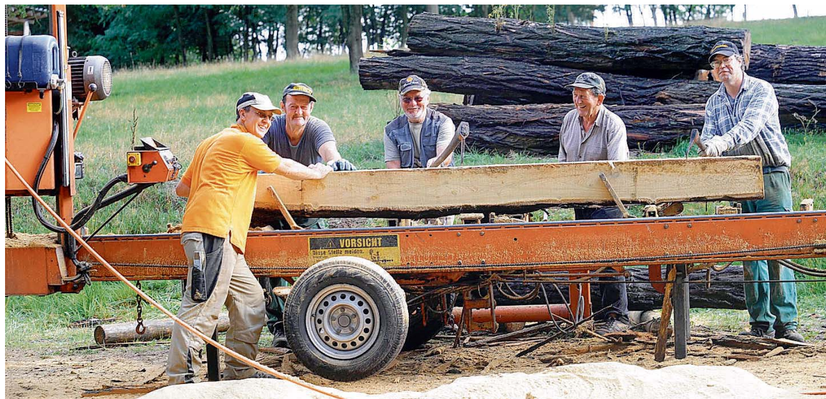
Gut gelaunt verarbeiten die Helfer des Landschaftspflegevereins Karlsbrunn die gespendeten Akazienstämme mit einem mobilen Sägewerk. Das Holz soll später als Befestigungen, Bänke und anderes von zwei neuen Wanderwegen dienen. Foto: Jenal
